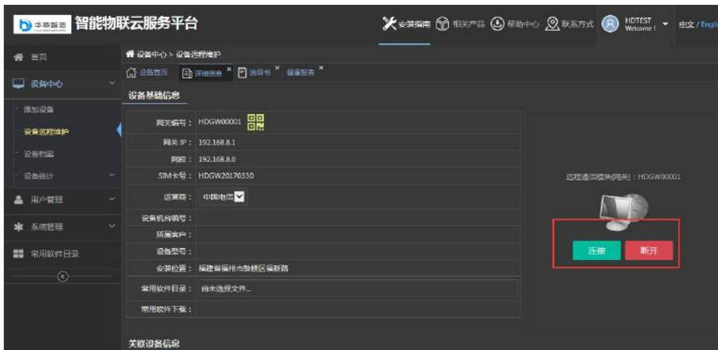
连接成功会提示以下内容，远程使用结束点击断开即可。到此即可正常使用远程功能，远程连接相应设备。（比如可用 Siemens STEP7 等编程软件从连接的 PLC 中上下下载程序，也可以用 EBPro 等组态软件在线模拟 HMI 人机界面。）
